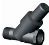
IVPRP.XXX 3/4'' BM-KM nyomásszabályzó 1,1 bar - 1,4 bar (0,8-5m 3 /h)
